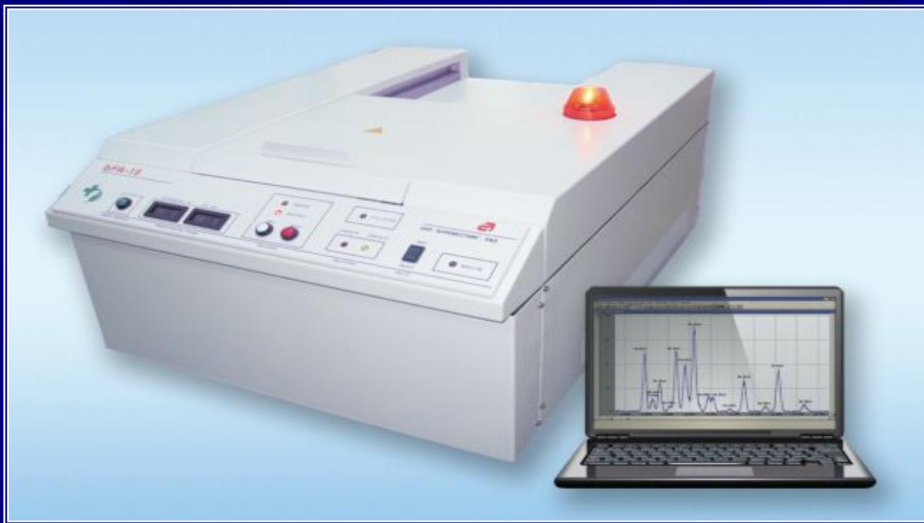
Определение химических элементов от Na до U
