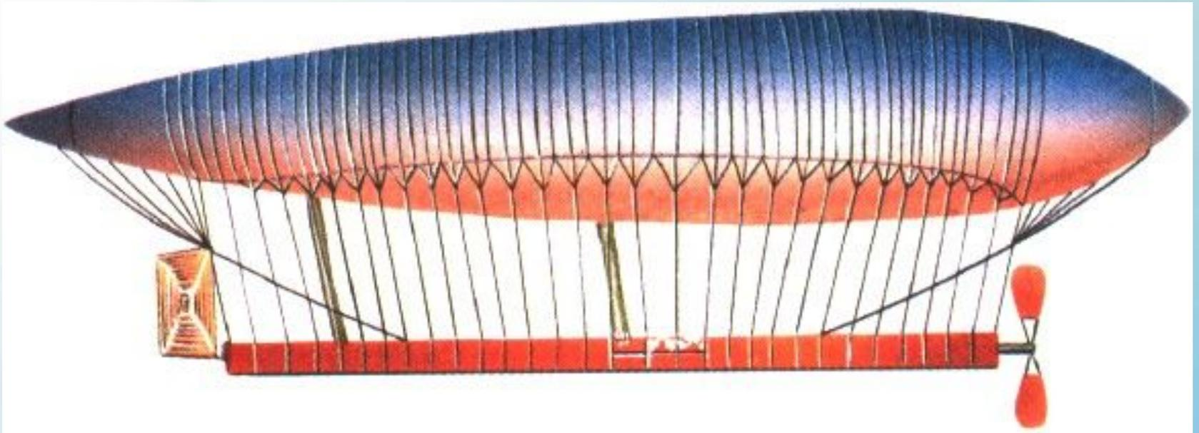
Оболочка дирижабля полужесткая веретенообразной формы, электродвигатель мощностью около 9 л.с., химический источник питания. Пролетел 8 км со скоростью 23,5 км./ч. и приземлился на месте старта
