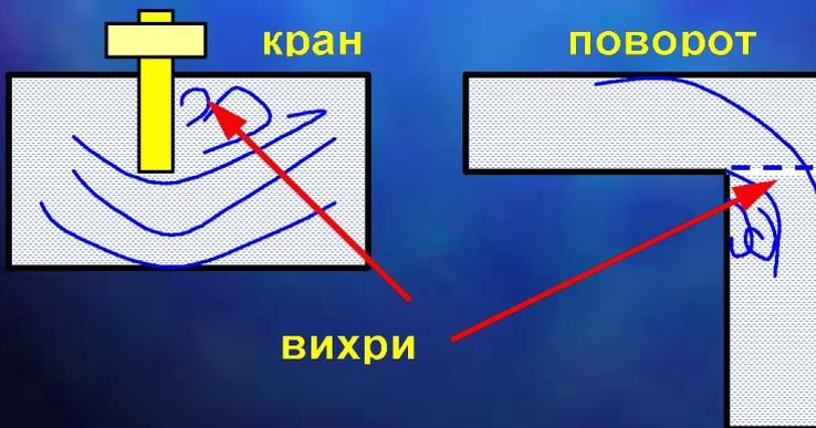
Энергия тратится на работу по преодолению силы инерции при деформации потока и на вихреобразование
