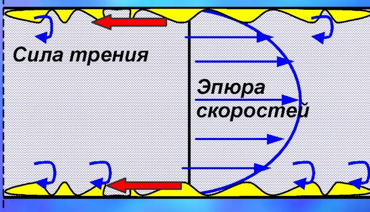
Энергия тратится на работу по преодолению силы трения и на вихреобразование при обтекании микронеровностей стенки турбулентным потоком
