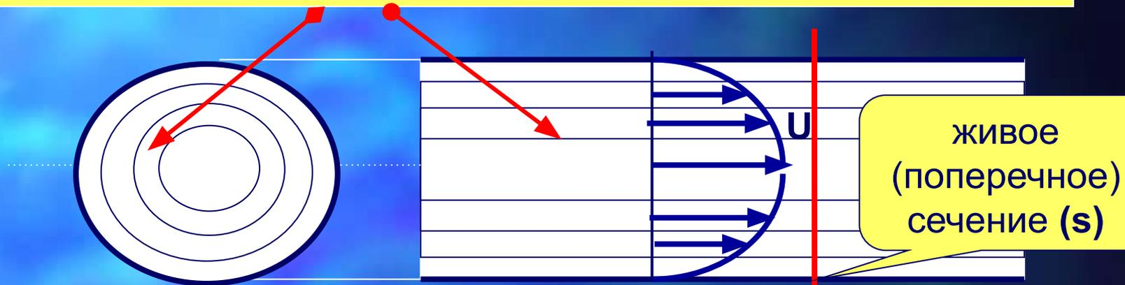
**Поток жидкости** – совокупность элементарных струек, движущихся с разными скоростями
