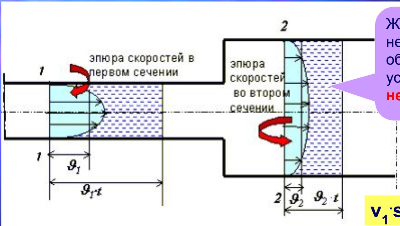
Жидкость несжимаема и в ней невозможно образование пустот. Это условие **сплошности** или **неразрывности** движения
