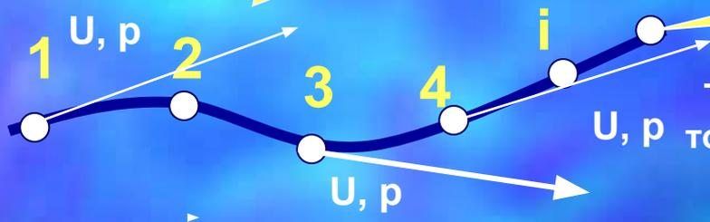
Траектория жидкой частицы – геометрическое место точек, являющихся последовательными положениями движущейся частицы
