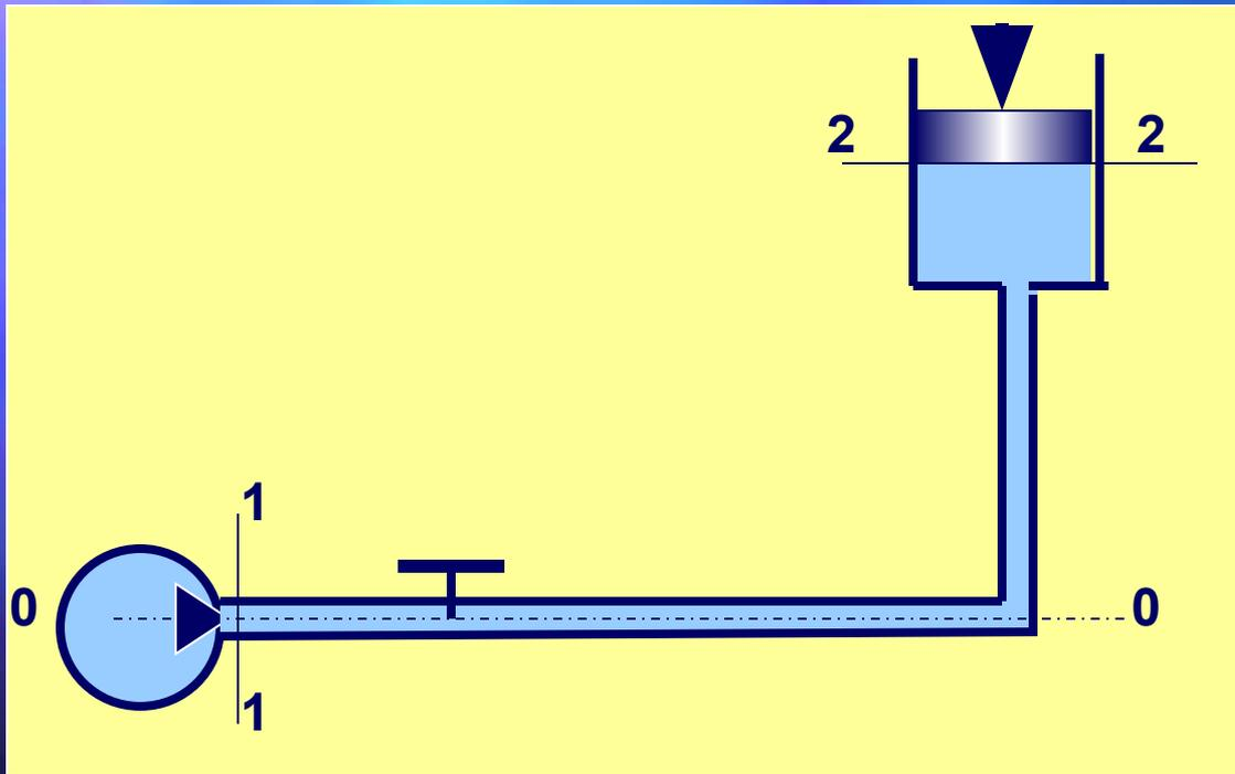
Потери удельной энергии (напора) при движении жидкости от сеч. 1-1 к сеч. 2-2:
