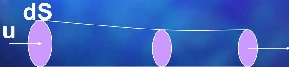
Часть потока, заключенная внутри трубки тока – элементарная струйка
