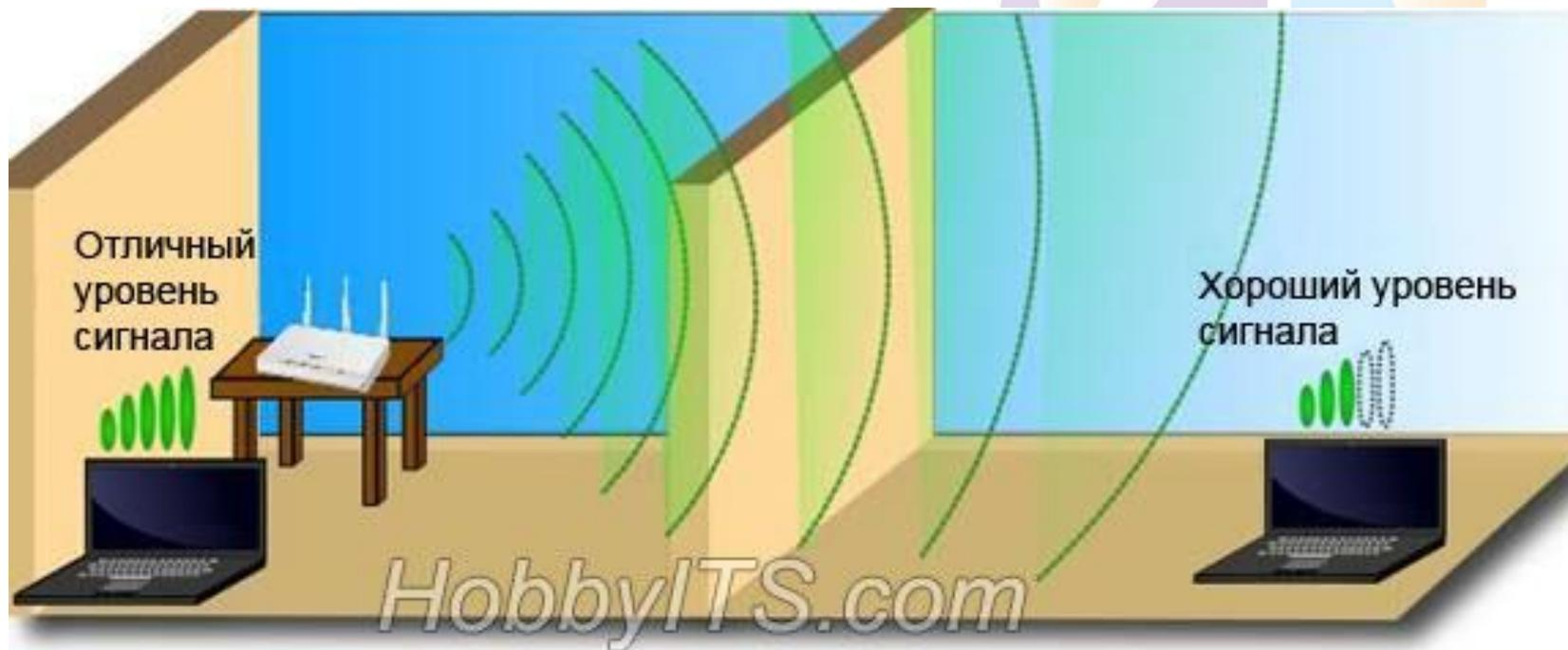
Конструкции и объекты, которые встречаются на пути Wi-Fi сигнала в зависимости от материала из которого они сделаны, по-разному влияют на радиус действия беспроводной сети.
