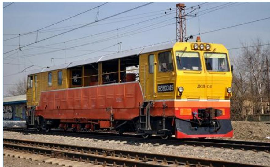
При разовом проходе динамического стабилизатора пути для стабилизации балластной призмы необходимо пропустить 300-400, двухразовом проходе – 200-300, трехразовом проходе – 100-200, а четырехразовом проходе – 100 тыс. тонн груза (брутто). При выполнении работ в режиме «закрытого перегона» выполняется **пятикратный** проход динамического стабилизатора.
