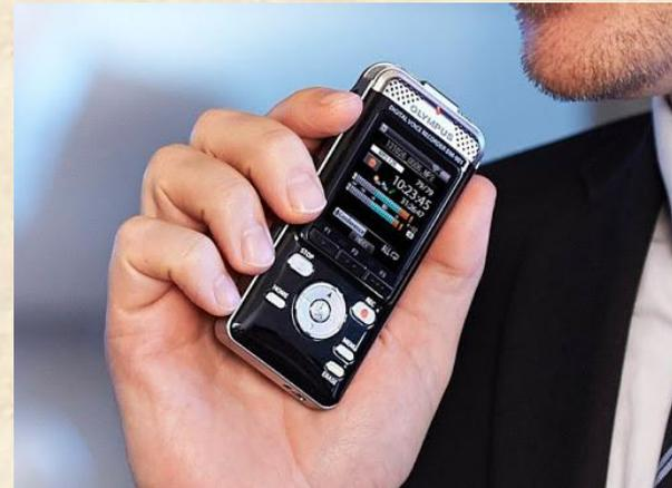
С 1997 г. началось производство цифровых диктофонов. В них запись звука, преобразованного в цифровой код, производится не на магнитную ленту, а на микрочип (встроенную интегральную схему памяти) или миникарты. Записанную таким образом на миникарту информацию можно с помощью специального устройства вводить в компьютер, прослушивать или пересылать по электронной почте.
