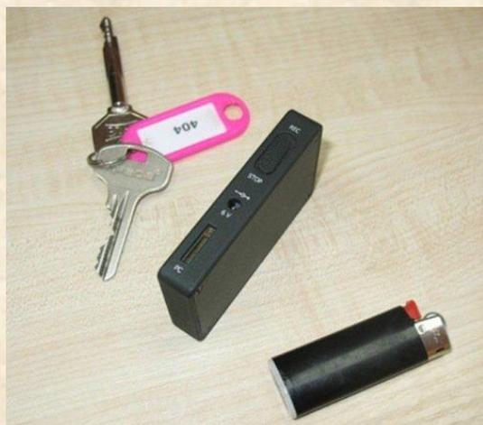
Одной из Санкт-Петербургских компаний выпускаются цифровые диктофоны серии «Гном», имеющие габариты 73x47x12,5 мм, т. е. чуть больше спичечной коробки. Будучи оснащенными встроенной флэш-памятью объёмом 1 Гб, они позволяют записывать и хранить до 37 часов звуковой информации. Такого рода звукозаписывающие устройства используются, в частности, бизнесменами, юристами, студентами.
