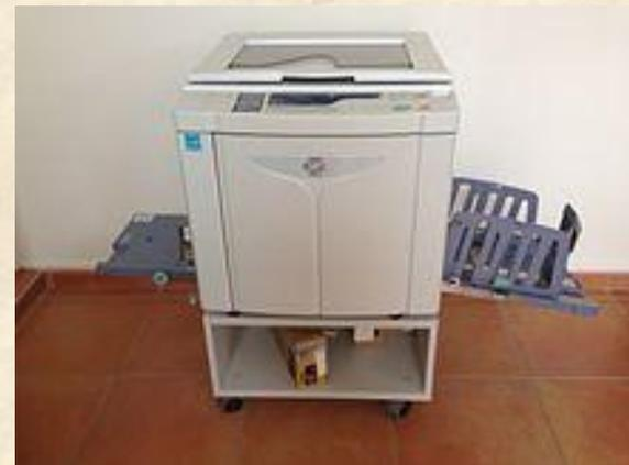
При копировании сначала документ переводится в электронный вид и по нему создается матрица (пленка с микроотверстиями). Затем рабочая матрица пропитывается красителем и используется как трафарет для печати. С одной рабочей матрицы можно получить не менее 4000 оттисков хорошего качества.
