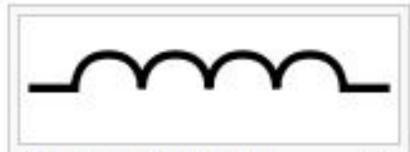
Обозначение на — электрических принципиальных схемах
