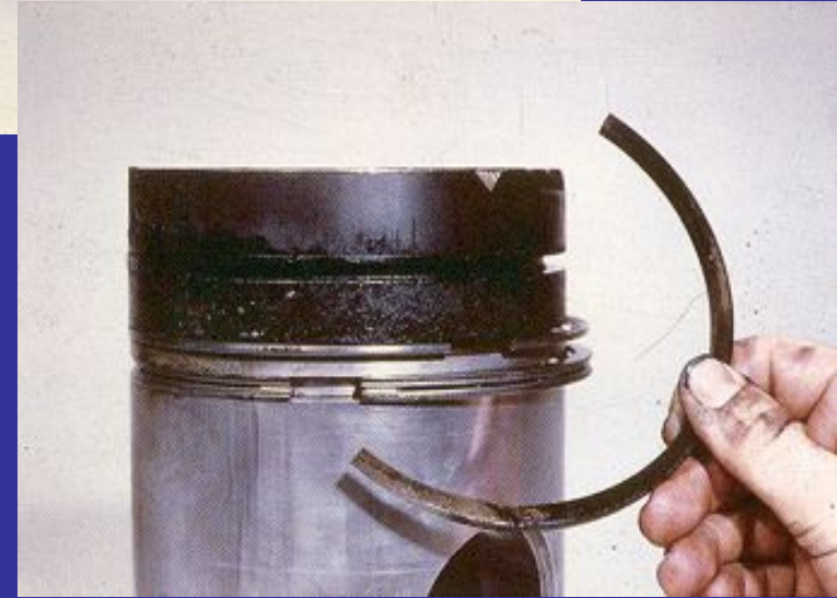
Несоблюдение процедуры установки колец
