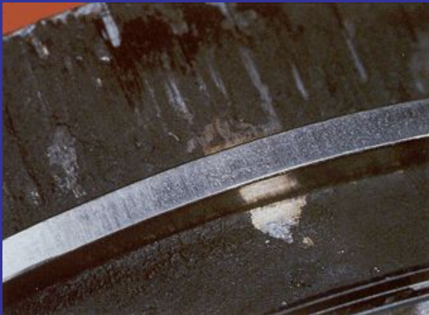
Неудовлетворительная работа воздушных фильтров
