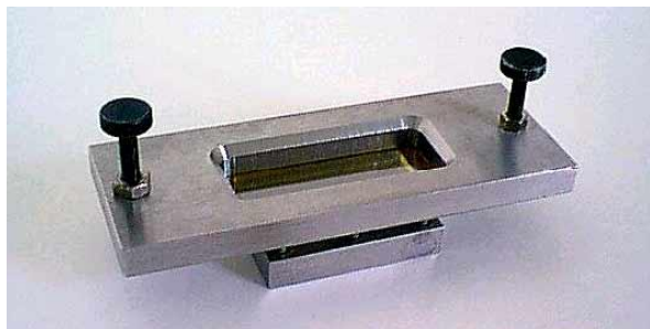
Приставка многократного нарушенного полного внутреннего отражения (МНПВО)
