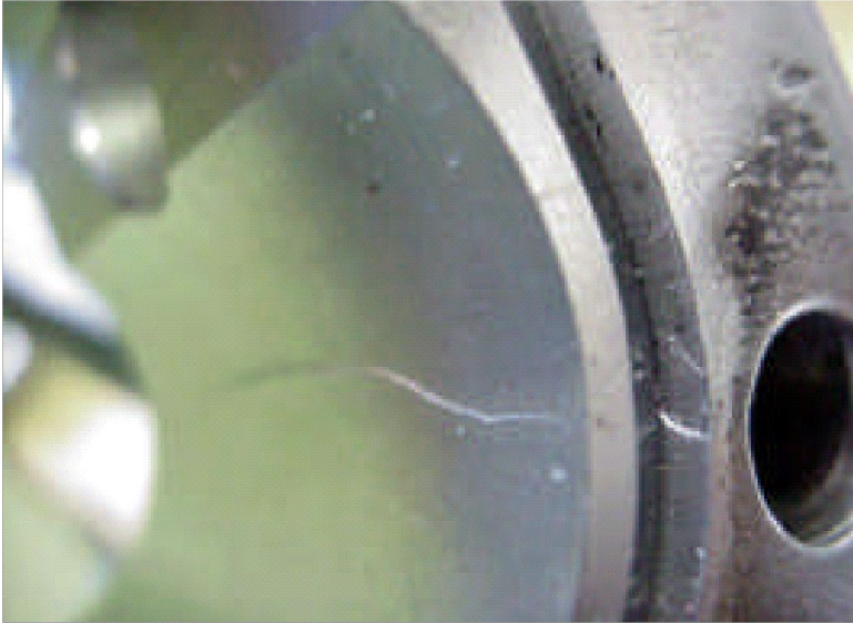
Разрушение корпуса насоса
