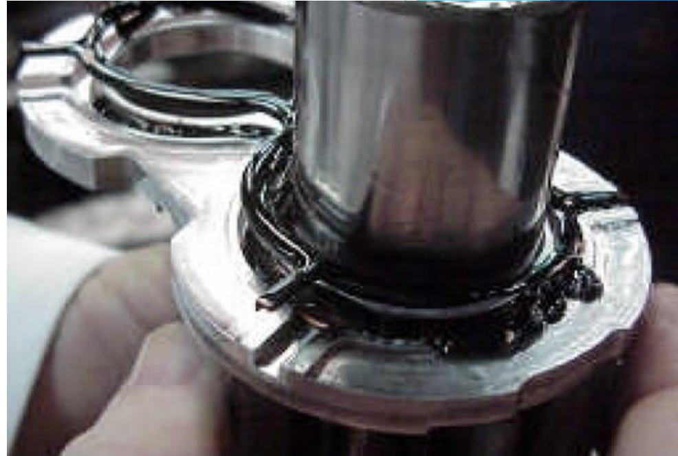
Эрозионный износ подпятника
