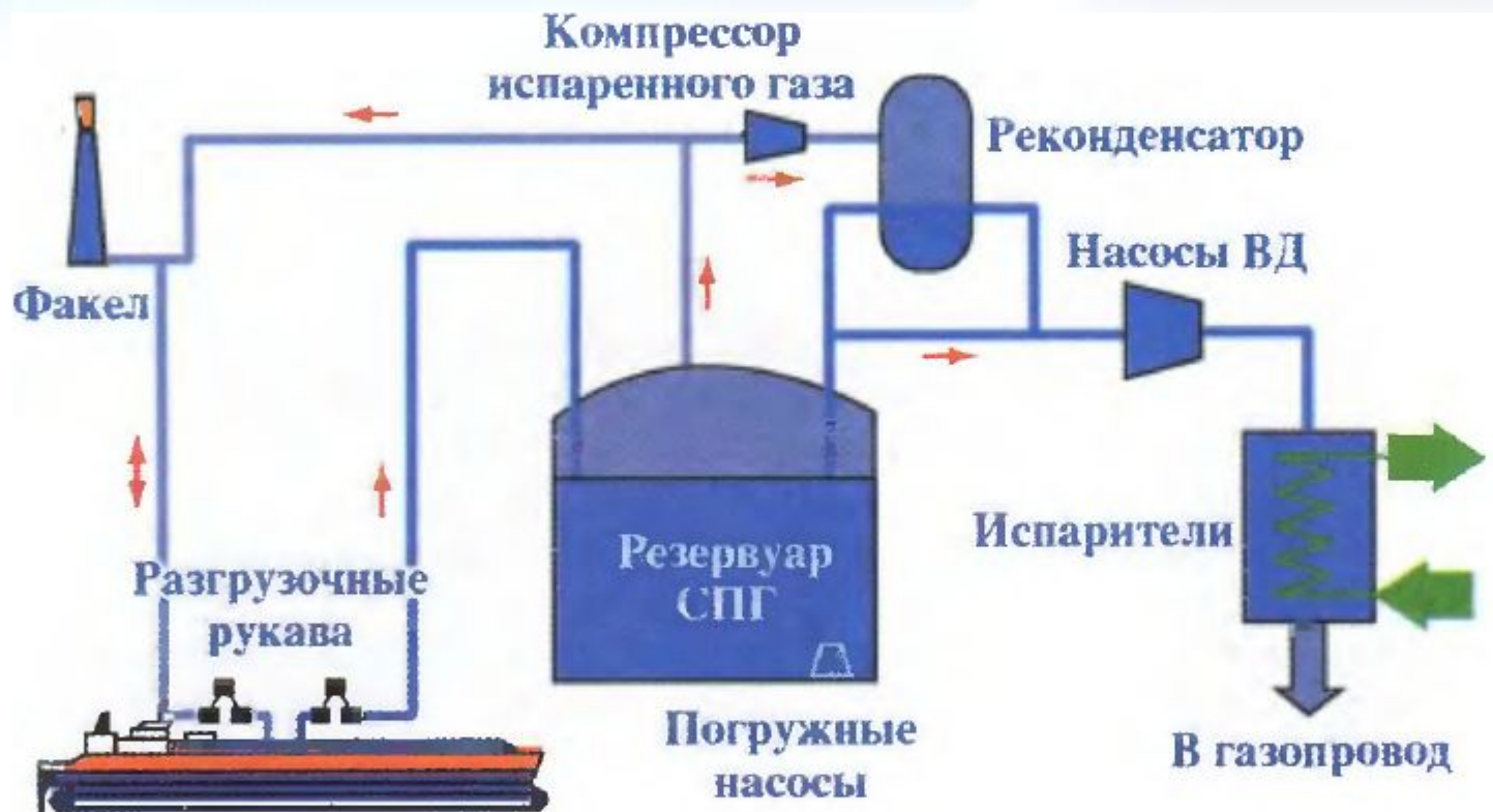
Рис. 5 - Принципиальная схема регазификационного терминала.
