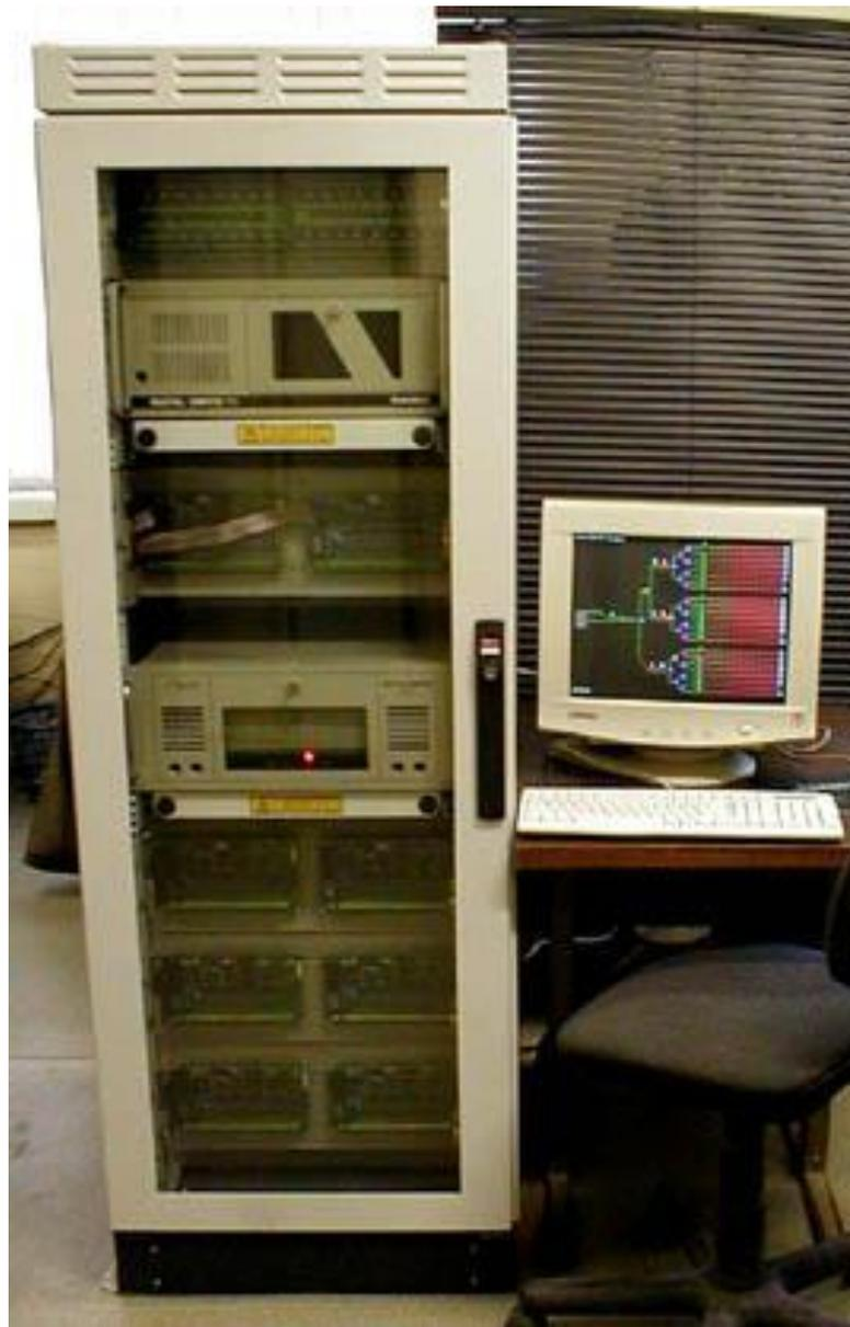
**Управляющий вычислительный комплекс** состоит из трех или более промышленных компьютеров, которые смонтированы в компоновочной стойке с клеммными полями для подведения сигналов от напольных устройств и рабочих мест.
