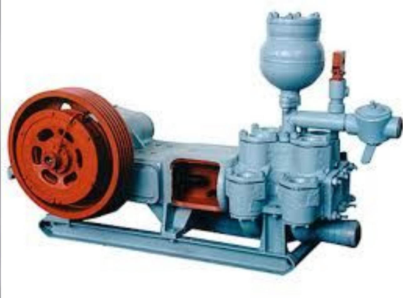
При подготовке буровых насосов к спуску и цементированию колонны проверяют состояние штоков, сальниковой набивки, гнезд, клапанов, соединений в приводной части и все замеченные дефекты ликвидируют, а сработанные детали заменяют новыми.
