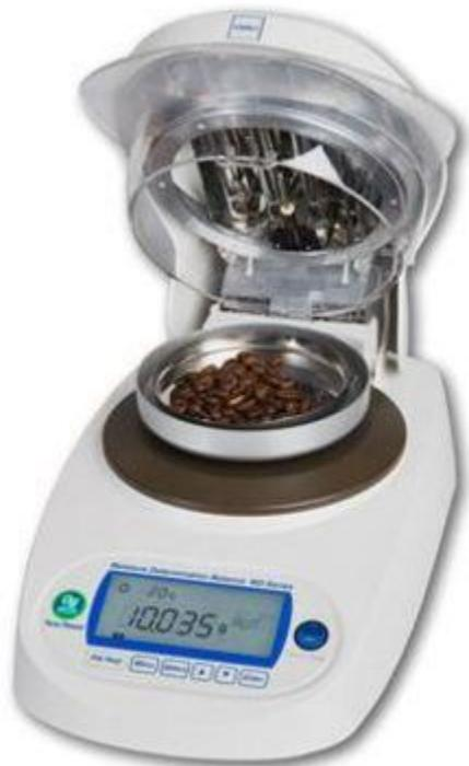
Оснащен самой большой в классе платформой, встроенным микролифтом и карбоновым конвектором с увеличенным сроком службы. Измерение влажности проводится путем сравнения массы исходного образца и после полного его высушивания.
