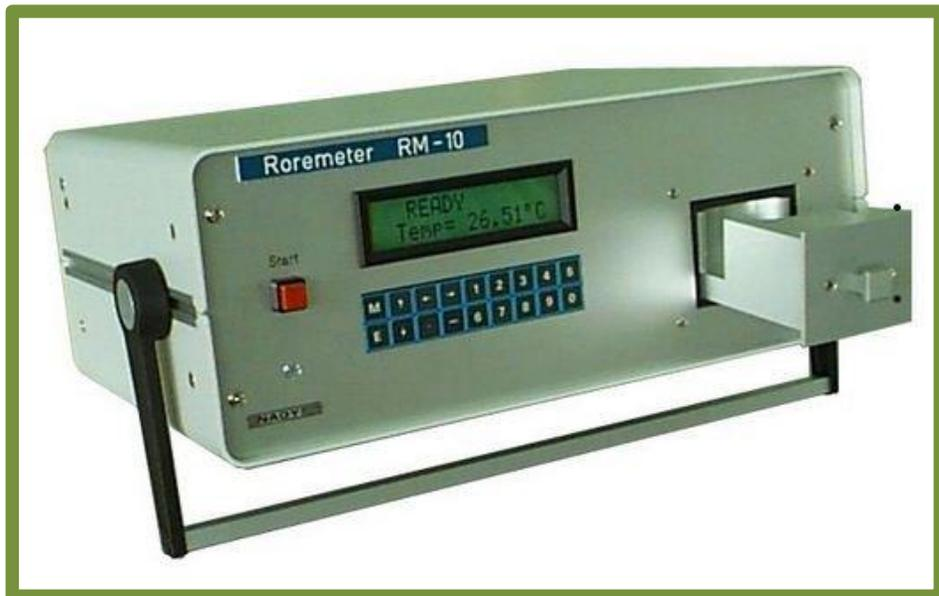
**Принцип работы** анализатора основан на измерении точки росы равновесного воздуха. Метод измерения базируется на физической связи между температурой конденсации (точка росы) водяного пара и содержанием водяного пара в воздухе. По результатам измерения точки росы и температуры пробы анализатор вычисляет значение показателя активности воды в исследуемом образце.
