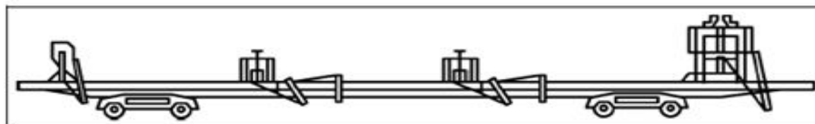
Рис.10.2 – Железнодорожная секция 1 – агрегат для транспортирования ГО; 2, 3 – агрегаты для транспортирования 1-й и 2-й ступеней РН
