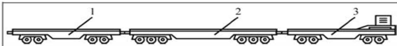
Рис.10.2 – Железнодорожная секция 1 – агрегат для транспортирования ГО; 2, 3 – агрегаты для транспортирования 1-й и 2-й ступеней РН
