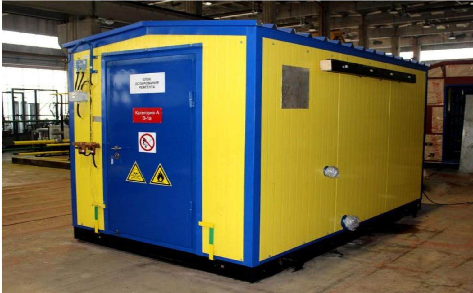
Блоки реагентные обеспечивают приготовление и дозирование химреагентов различного назначения в любую точку технологической цепи «скважина - установка подготовки нефти».
