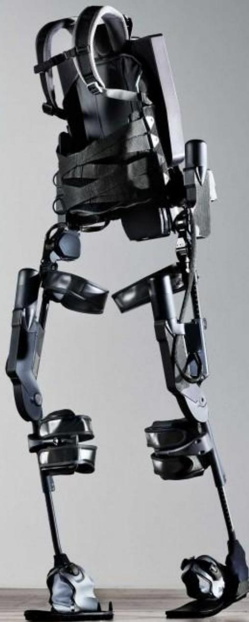
**Экзоскелет – робот со следящим приводом, управляемый человеком, соединенным зажимами с роботом.**
