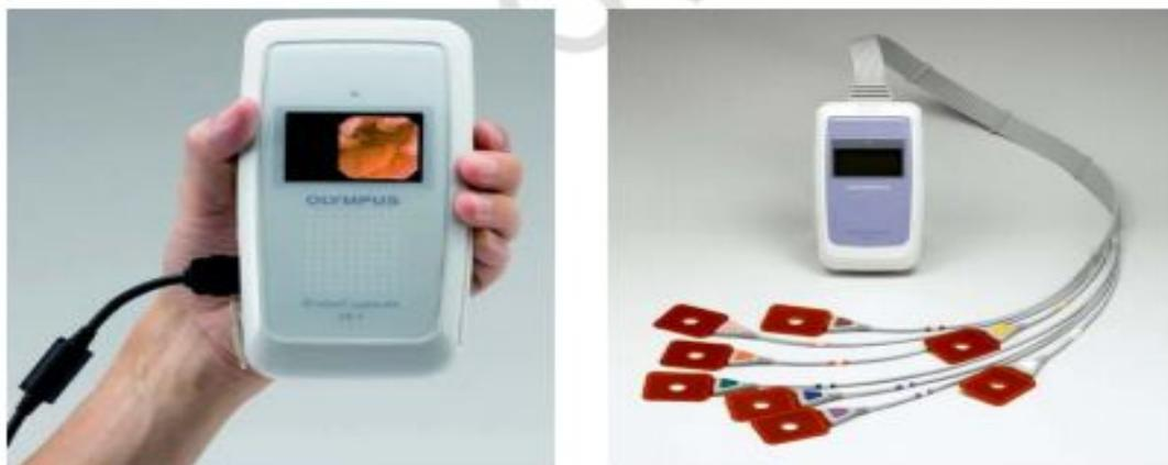
Рис. 17. Считывающее устройство и электроды, регистрирующие сигналы, посылаемые видеоэндокапсулой, при прохождении по ЖКТ
