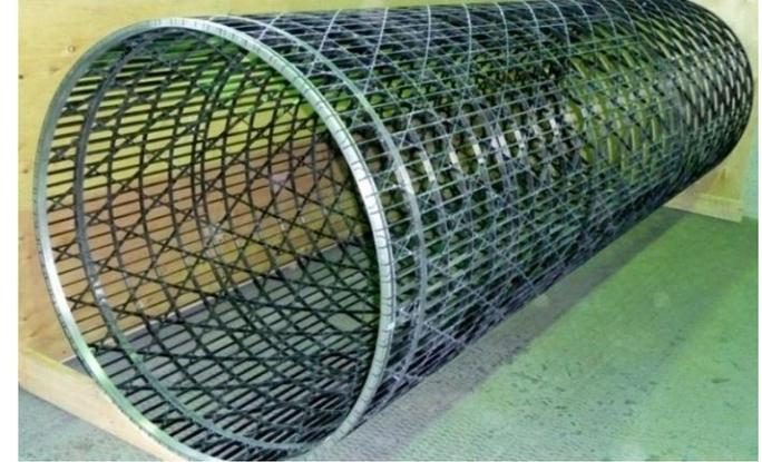
Несущая конструкция космического аппарата
