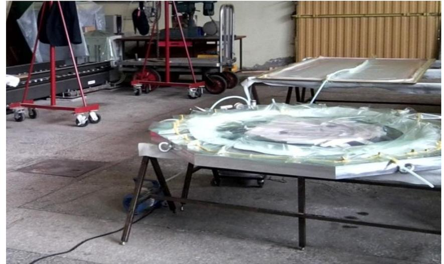
Антенный рефлектор изготовлен из полимерного КМ с низкой плотностью, высокой жесткостью и размеростабильностью в условиях эксплуатации в диапазоне температур от минус 160°С до +140°С. Рабочая частота данной антенны должна составлять  $\vartheta = 60$  ГГц ( $\Delta < 10^{-4}$  м).
