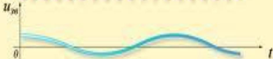
Низкочастотная звуковая волна
