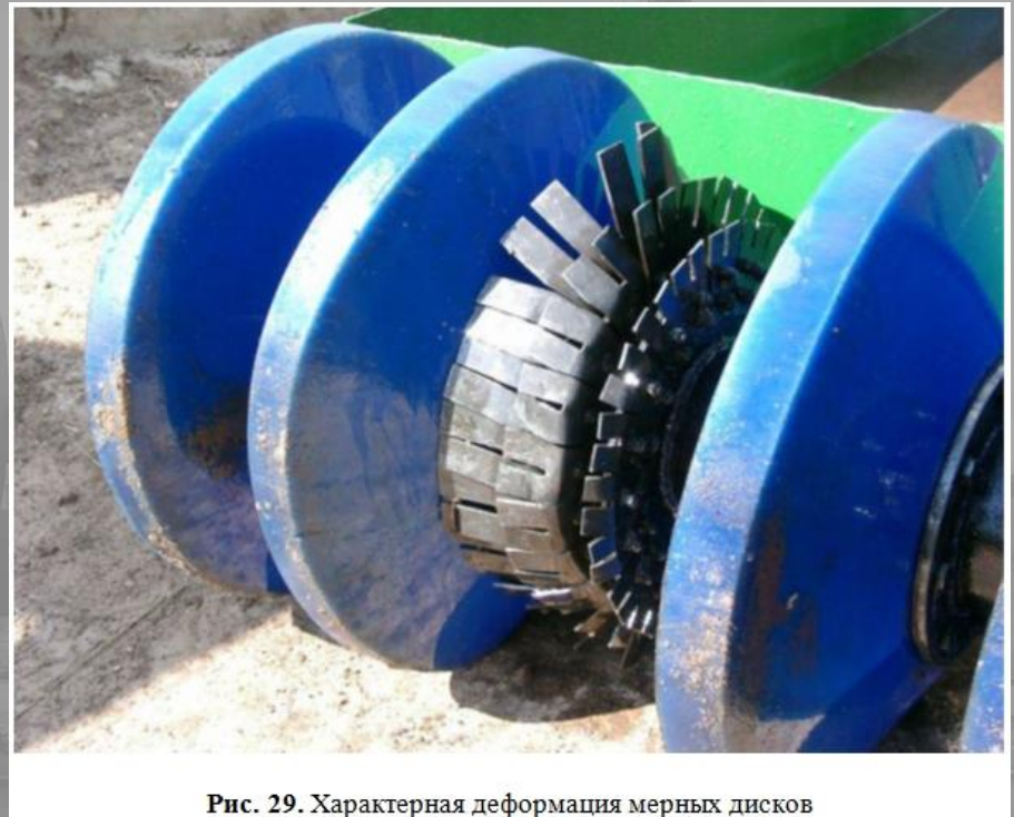
Рис. 29. Характерная деформация мерных дисков
