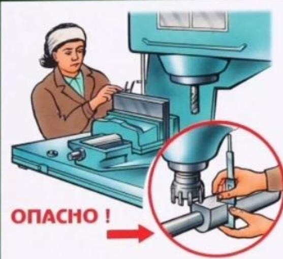
При измерении детали отведите фрезу на безопасное расстояние
