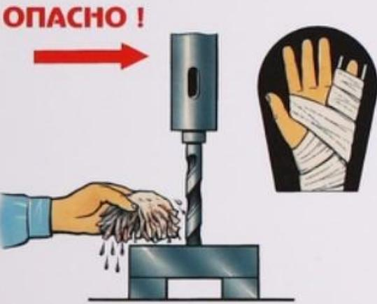
Подавать охлаждающую жидкость на сверло смоченными обтирочными концами
