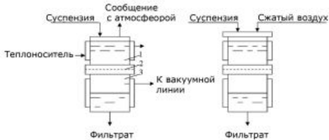
Рис. 7.10. Устройство аппаратов для фильтрации: а – мембранный-фильтр; б – друк-фильтр
