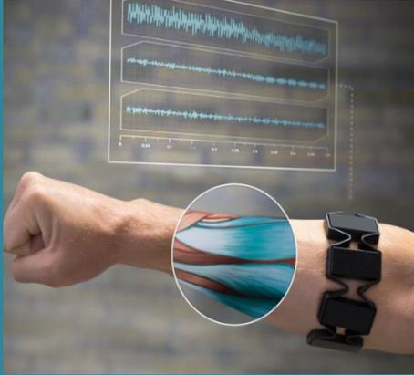
Браслет MYO состоит из 8 модулей, соединённых специальными эластичными клипсами. Все части устройства выполнены из приятного на ощупь пластика.
