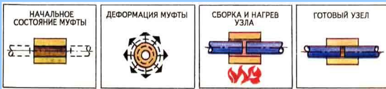
Рис. Схема технологического процесса соединения двух трубок с использованием втулки из высокотемпературного запоминающего сплава
