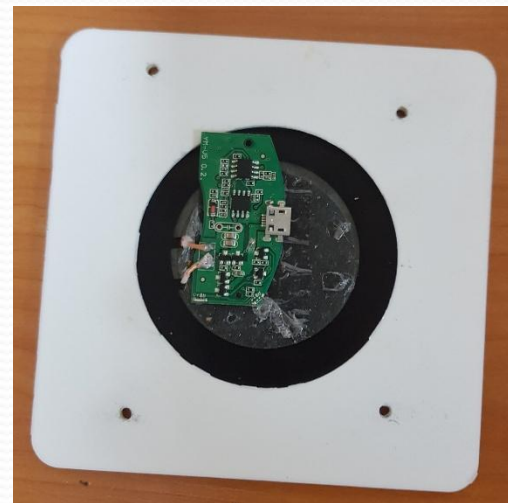
Устанавливаем модуль беспроводной зарядки
