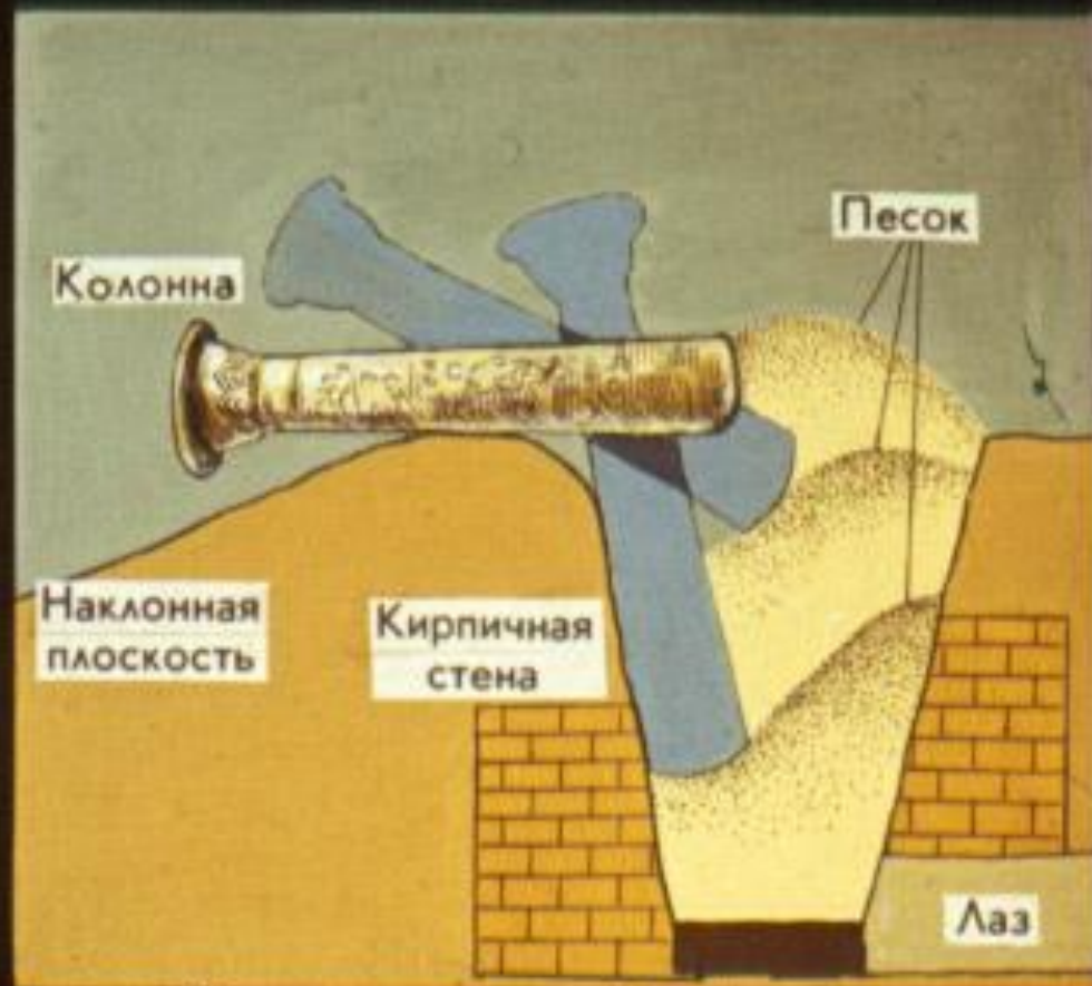
Установка колонны на фундамент.
