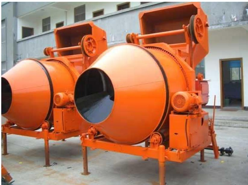
Во избежание возникновения *центробежных сил*, препятствующих свободной циркуляции смеси внутри барабана, частота его вращения обычно не превышает 0,3...0,4 с<sup>-1</sup>.
