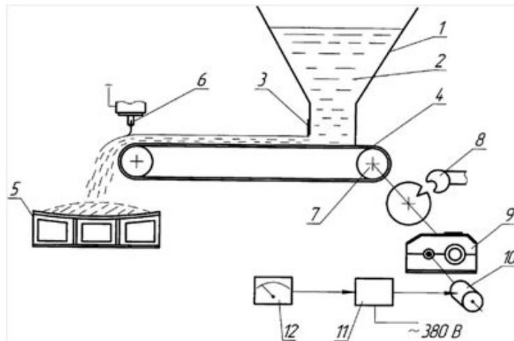
Дозатор непрерывного действия автоматический
