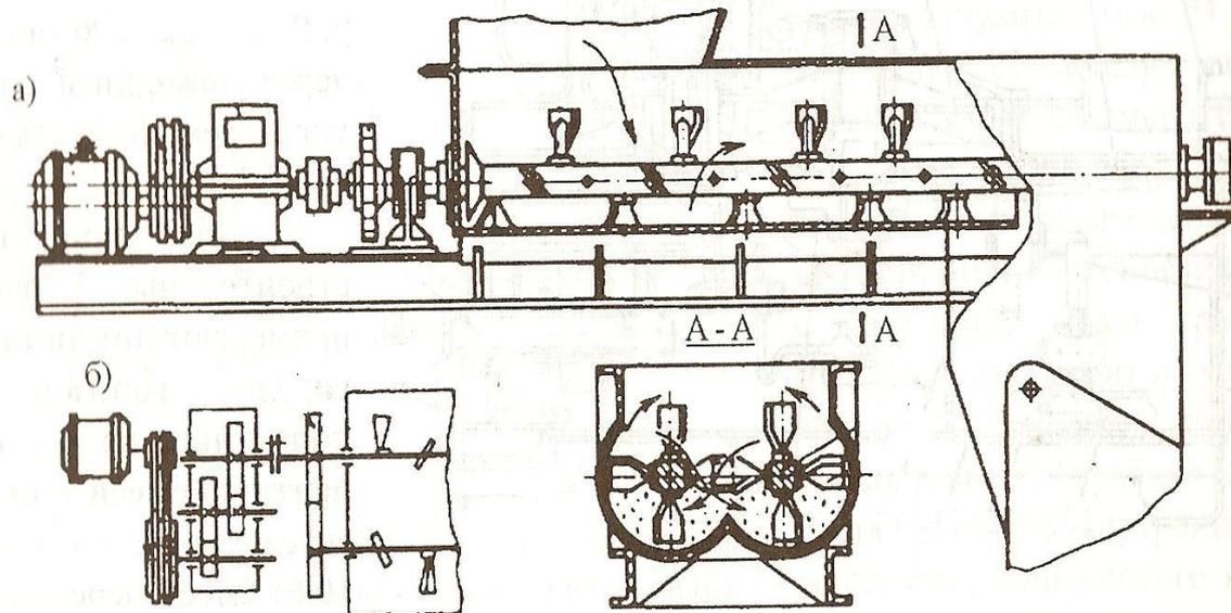
Двухвальный смеситель непрерывного действия (а) и кинематическая схема его привода (б)
