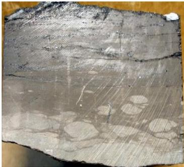
***Рис. Ископаемые почвы в керне скважин***
