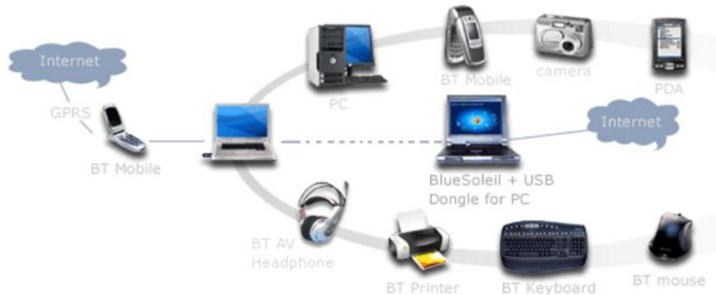
Принцип действия также основан на использовании радиоволн. Радиосвязь осуществляется в свободном от лицензирования ISM-диапазоне (2,4-2,4835 ГГц). В Bluetooth применяется метод расширения спектра со скачкообразной перестройкой частоты (FHSS). Данный метод прост в реализации, обеспечивает устойчивость к широкополосным помехам, к тому же имеет низкую стоимость затрат на комплектующие.
