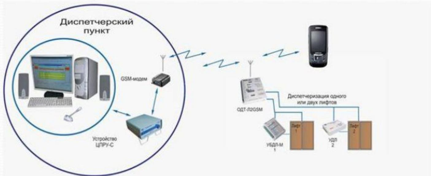
ОДТ-Л GSM - объектный диспетчерский терминал - лифтовый GSM
