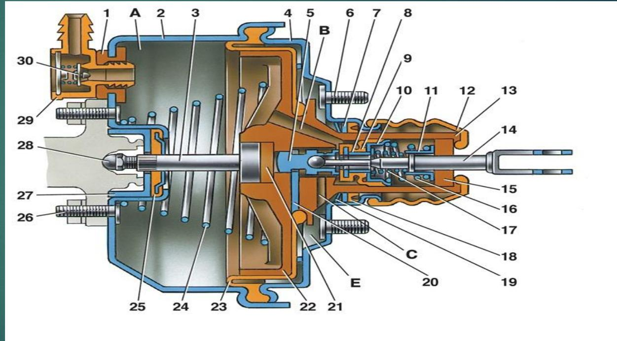
Вакуумный усилитель крепится к пластине кронштейна педалей сцепления и тормоза на четырех шпильках 6 (см. рис. **Вакуумный усилитель**) с гайками, а главный цилиндр – к вакуумному усилителю на двух шпильках 26. Между корпусом 2 и крышкой 4 зажат наружный поясok резиновой диафрагмы 23, которая делит усилитель на вакуумную А и атмосферную Е полости. Вакуумная полость через шланг с наконечником 29 и клапаном 30 соединяется с впускной трубой двигателя.
