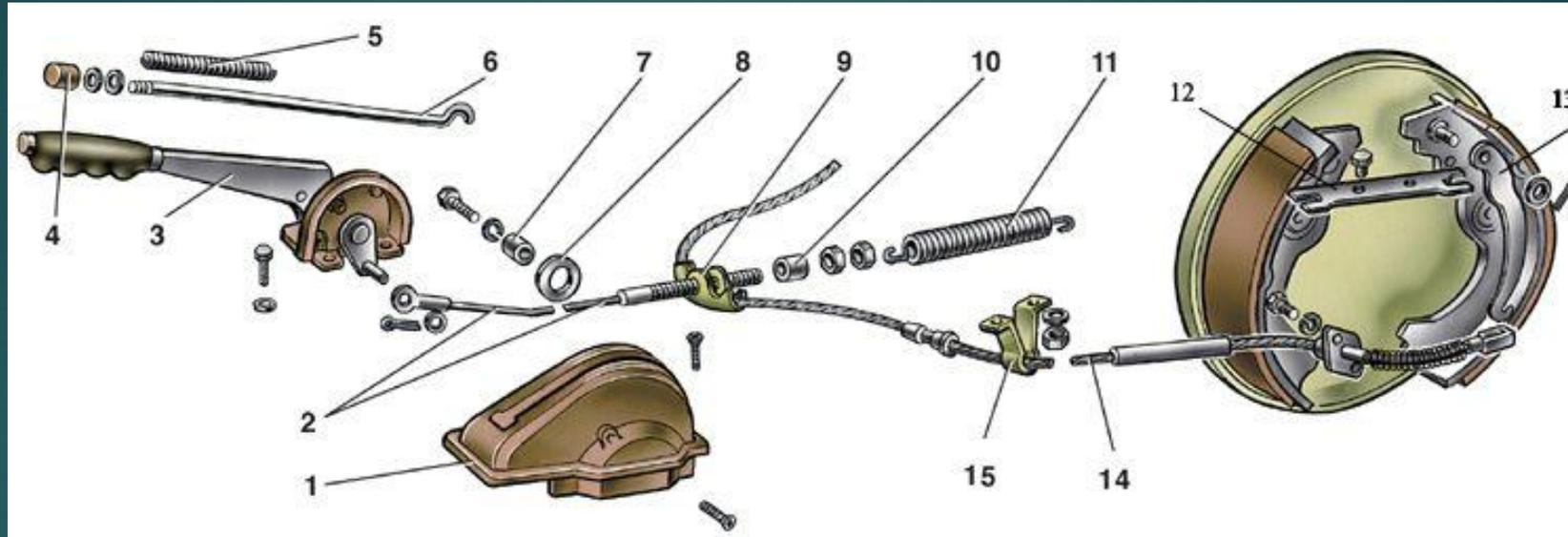
Стояночный тормоз имеет механический привод от рычага 3 (см. рис. **Детали привода стояночного тормоза**), который вместе с возвратным рычагом смонтирован на кронштейне, закрепленном к полу кузова. Возвратный рычаг соединяется пальцем с передним тросом 2, другой конец которого проходит через отверстие направляющей 9 заднего троса и на резьбовой наконечник троса накручивается гайка и контргайка. Перемещение переднего троса направляется роликом 8.
