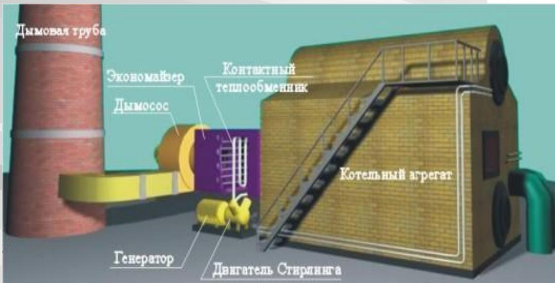
Когенерация - процесс совместной выработки электрической и тепловой энергии
