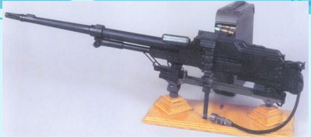
ПКТ — пулемёт Калашникова танковый, с более тяжёлым стволом и оборудованный электростпуском. Он устанавливается в башнях танков и других боевых бронированных машин
