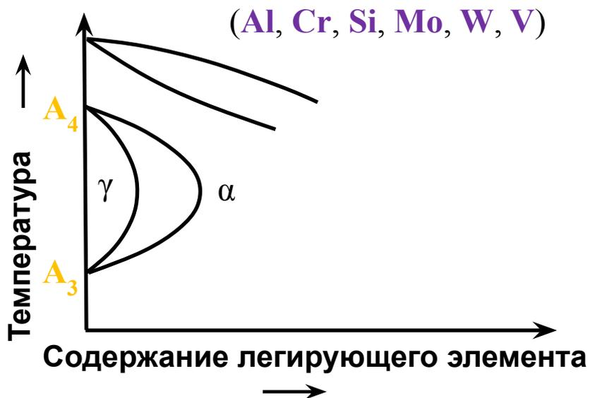
б) Элементы, образующие с железом сплавы, в которых  $\gamma$ -область ограничивается гетерогенной областью
