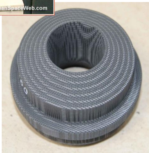
Внешний вид демонстратора соплового вкладыша РДТТ из УУКМ марки МКУ4М-7-У
