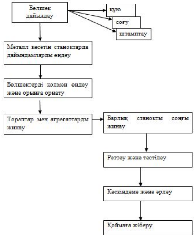
Вагон жөндеу зауытында өнімдерді өндірудің негізгі технологиялық схемасы
