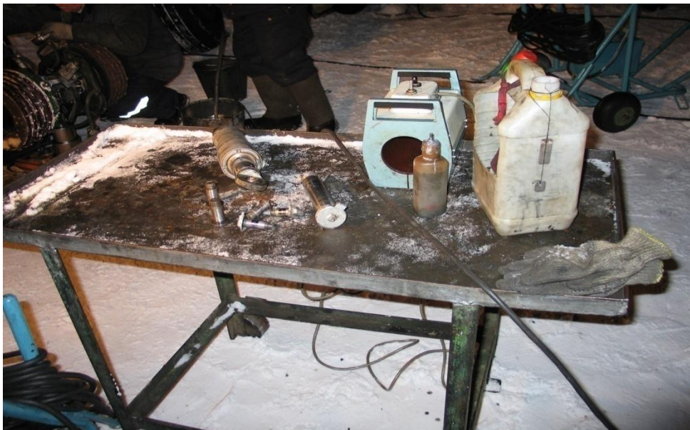
Рис. Рабочее место, для проверки деталей шасси неразрушающими методами контроля, развернутое непосредственно на месте стоянки самолета
