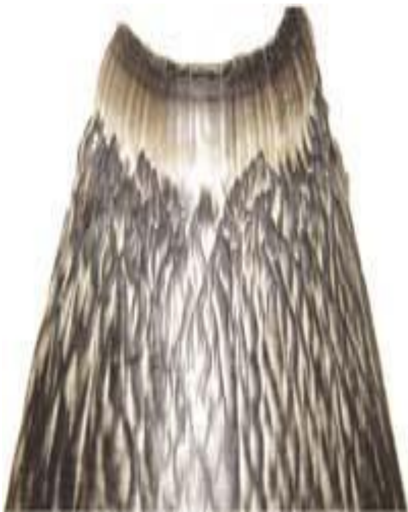
Поток топлива при расширении сопла
