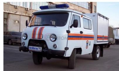
**Легкие АСА** - автомобили быстрого реагирования - выпускаются на шасси легковых и малотоннажных грузовых автомобилей, микроавтобусов. Они доставляют универсальный аварийно-спасательный инструмент и оборудование, позволяющие боевому расчету произвести разведку чрезвычайной ситуации и выполнить самые неотложные спасательные работы.
