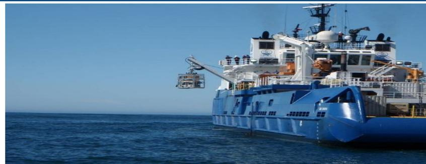
Услуга по выполнению подводно-технических работ с использованием ПАДУ требует **задействование специализированного судна**
