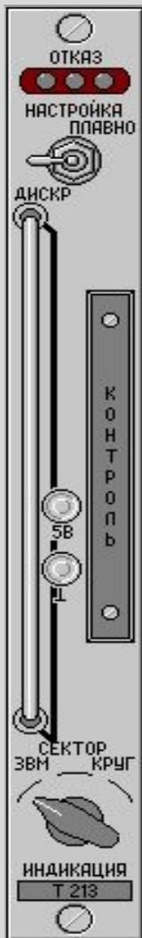
**T-213 – блок управления** – для обеспечения совместной работы блоков Т-204, Т-209, Т-214, Т-218 в соответствии с режимами функционирования аппаратуры Т-210. Блок осуществляет:
