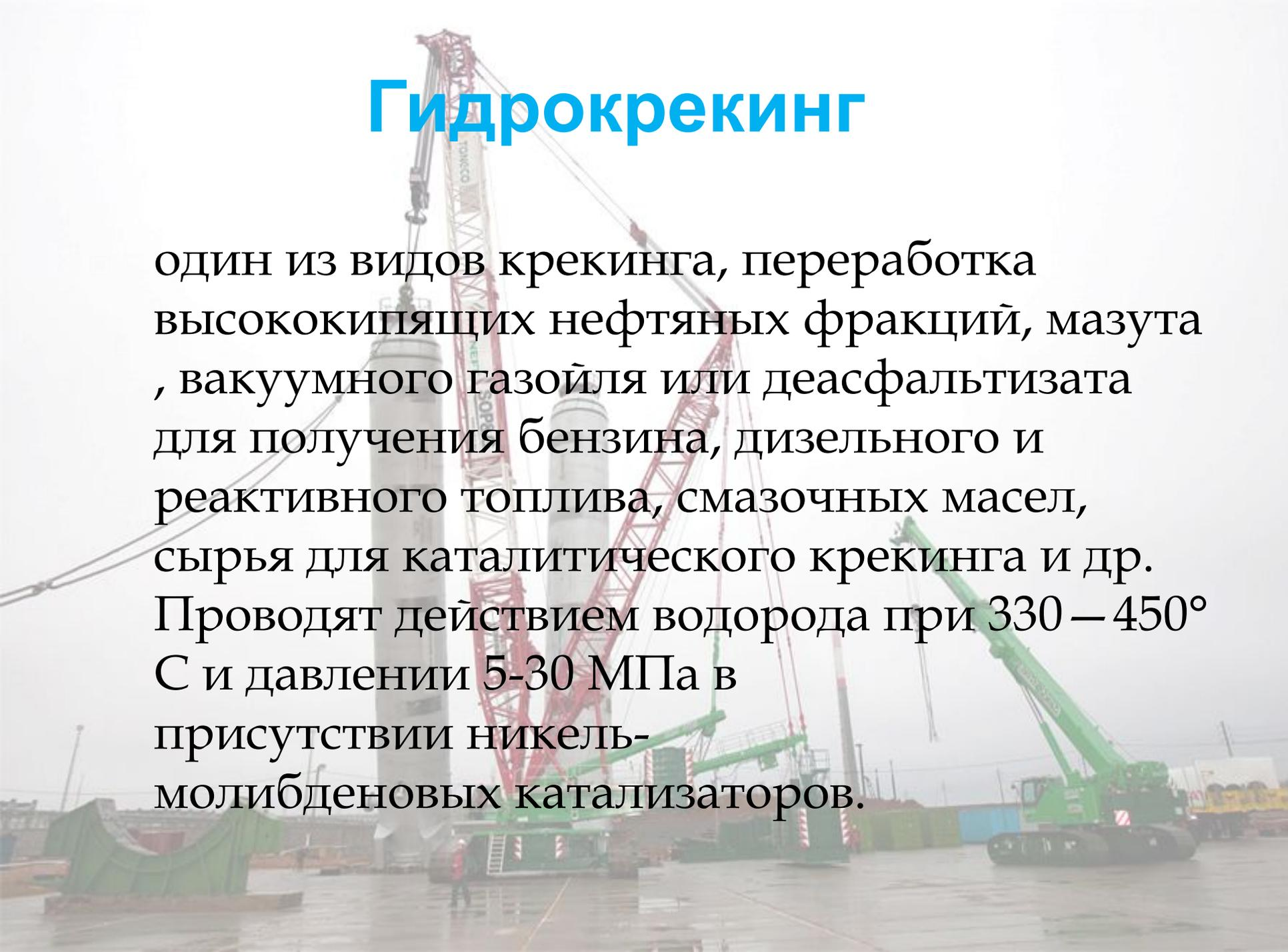
один из видов крекинга, переработка высококипящих нефтяных фракций, мазута, вакуумного газойля или деасфальтизата для получения бензина, дизельного и реактивного топлива, смазочных масел, сырья для каталитического крекинга и др. Проводят действием водорода при  $330 - 450^{\circ}\text{C}$  и давлении 5-30 МПа в присутствии никель-молибденовых катализаторов.
