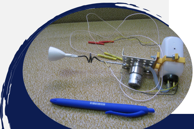
Прототип электронагревного реактивного двигателя создаваемого студентами МГТУ
