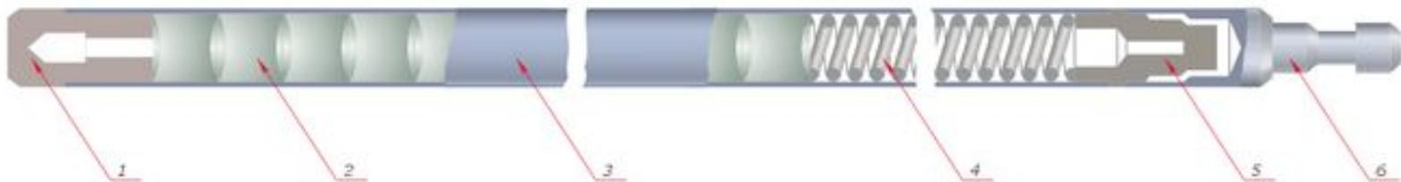
Устройство твэла реактора [РБМК](#) Устройство твэла реактора РБМК: 1 — заглушка; 2 — таблетки [диоксида урана](#) Устройство твэла реактора РБМК: 1 — заглушка; 2 — таблетки диоксида урана; 3 — оболочка из [циркония](#); 4 — пружина; 5 — втулка; 6 — наконечник.
