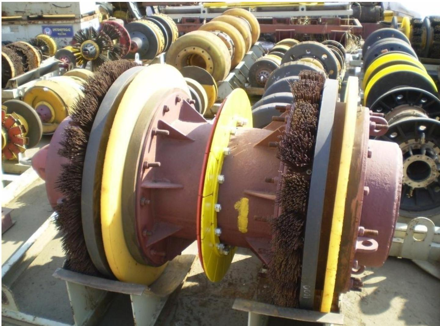
Если после пропуса **скребка-калибра** калибровочные пластины были загнуты, то пропуск **профилемера** после калибровки **обязателен.**
