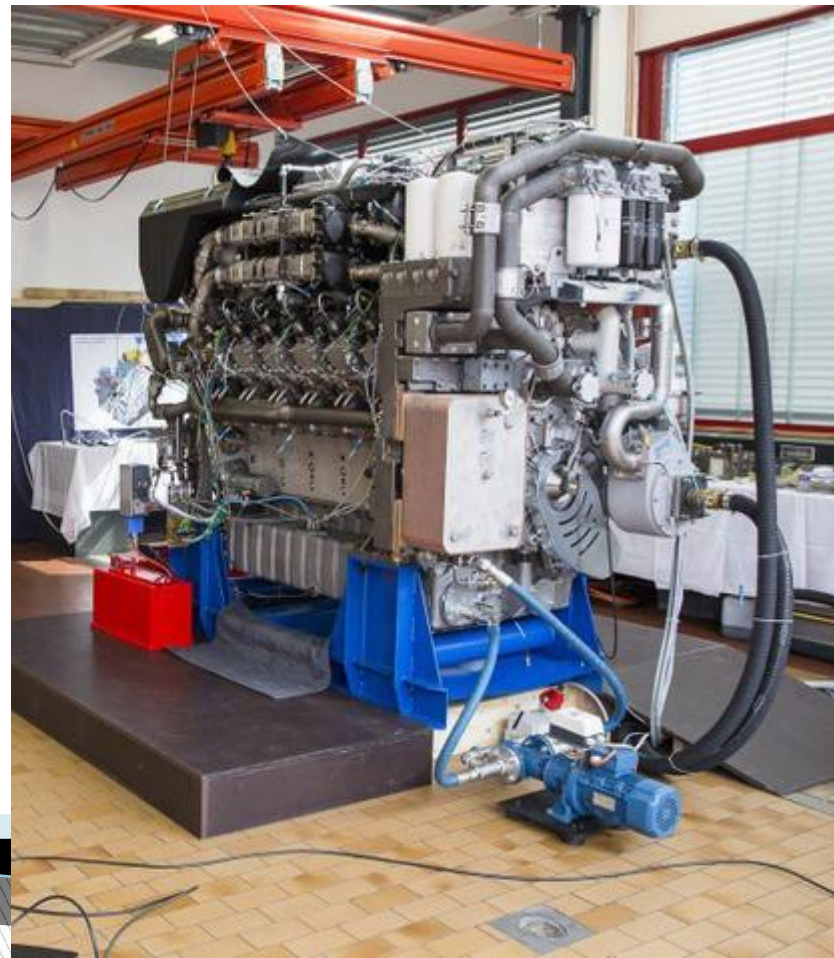
Новый 12-цилиндровый V-образный судовой высокооборотный дизельный двигатель
