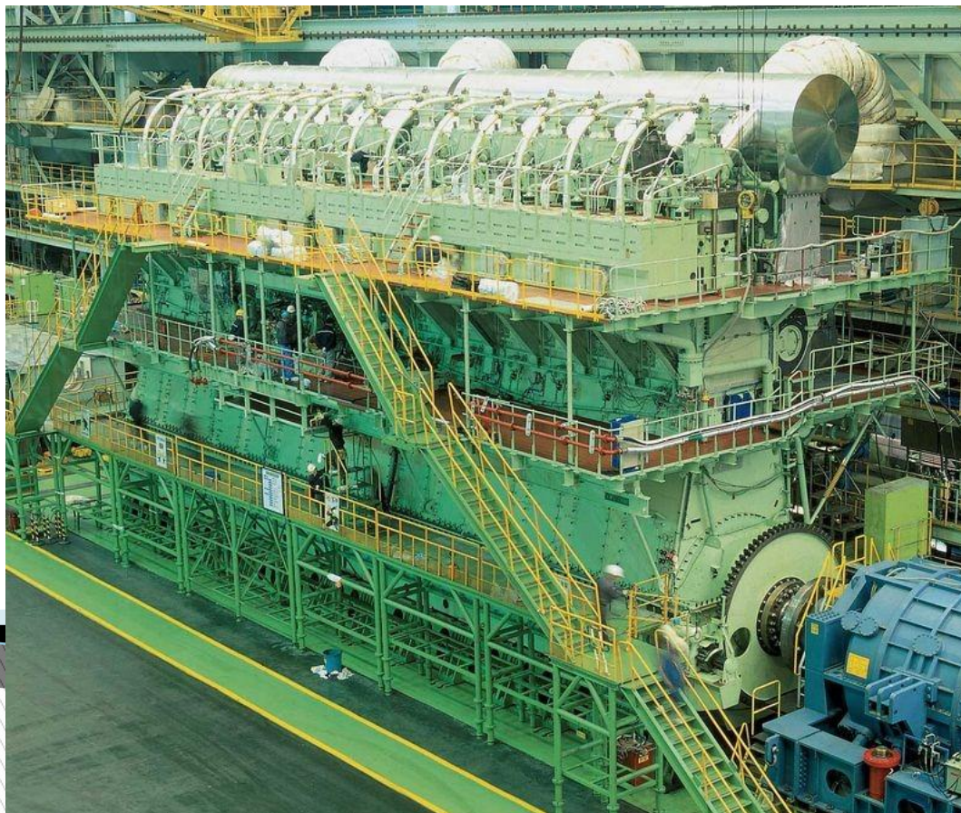
Дизель Wartsila-Sulzer RT – flex96C мощностью 80080 кВт
