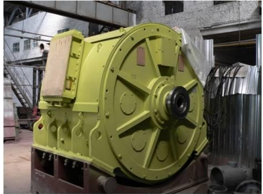
Гребной индукторный Электродвигатель ИД-2000/200.
