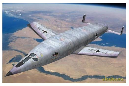
Длина — 28 м Размах крыльев ~ 15 м Сухая масса — 10 тонн Масса топлива – 84 тонны Полная стартовая масса – 100 тонн Теоретическая скорость полёта – 6400 м/с Теоретический потолок полёта – 260 км
