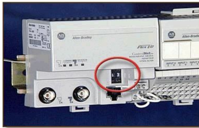
Адрес узла станции
