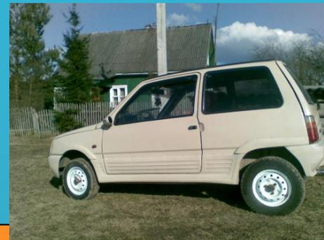
*Двухобъёмный, цельнометаллический, несущей конструкции, трёхдверный, с одним или двумя рядами сидений (VAZ-1111, -1113).*
