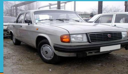
**Трехобъёмный, цельнометаллический, несущей конструкции с двумя или тремя рядами сидений и четырьмя боковыми дверями (автомобили ГАЗ-31029, -3102, ВАЗ-2110 и др.)**
