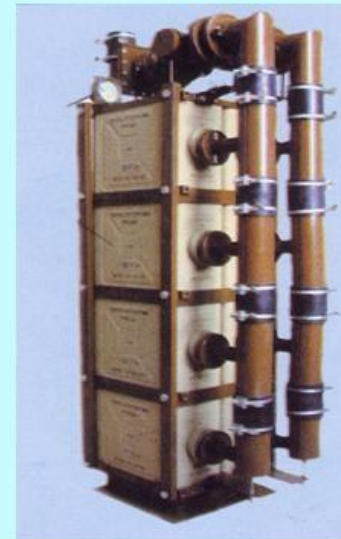
Общий вид регенеративных патронов
